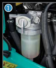
① Voorfilter met ingebouwde waterafscheider
