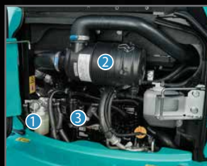
① Voorfilter met ingebouwde waterafscheider
